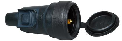
Gummi-Schutzkontakt-Kupplung, IP44, mit Steckerverriegelung, mit Spritzwasserschutzkappe und Knickschutztülle, verriegelt alle Stecker mit Führungsnocken bis 7mm Länge, bruchfest, schlagfest, Einsatz: Polyamid, Kappe: Gummi, für Kabelquerschnitte bis 3x2,5mm<sup>2</sup>, 16A, 250V~, schwarz
