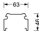
Schnellmontagesystem Tragschiene; Tragschiene aus profiliertem, verwindungssteifen Stahlblech, vorverzinkt; Gehäusefarbe Verkehrsweiß RAL 9016; Flachbandleitung werkseitig eingelegt und auf Schnellmontage-Buchsenteil verdrahtet. Wahlweise bestückbar mit Geräteträgern LED, T5 oder T8. Anschluss- und Montagezubehör sowie Schienen-Endstücke und Verbinder separat bestellen.
