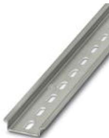
Tragschiene gelocht, Standardprofil, Breite: 35 mm, Höhe: 7,5 mm, nach EN 60715: 2001, Material: Stahl, verzinkt, dickschichtpassiviert, Länge: 955 mm, Farbe: silber
