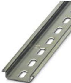
Tragschiene gelocht, Standardprofil, Breite: 35 mm, Höhe: 7,5 mm, nach EN 60715: 2001, Material: Stahl, verzinkt, dickschichtpassiviert, Länge: 755 mm, Farbe: silber
