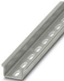
Tragschiene gelocht, Standardprofil, Breite: 35 mm, Höhe: 15 mm, ähnlich EN 60715: 2001, Material: Stahl, verzinkt, dickschichtpassiviert, Länge: 955 mm, Farbe: silber
