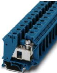
Installationsklemme, Schraubanschluss, Querschnitt: 0,75 mm<sup>2</sup> - 35 mm<sup>2</sup>, AWG: 18 - 2, Breite: 15,2 mm, Farbe: blau, Montageart: NS 35/7,5, NS 35/15, NS 32
