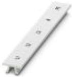
Marker für Klemmen, Streifen, weiß, beschriftet, längs bedruckt: L1, L2, L3, N, PE, Montageart: verrasten in hoher Schildchennut, für Klemmenbreite: 15,2 mm, Schriftfeldgröße: 10,5 x 15,1 mm
