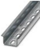
Tragschiene gelocht, Standardprofil, Breite: 35 mm, Höhe: 15 mm, ähnlich EN 60715: 2001, Material: Stahl, verzinkt, Länge: 2000 mm, Farbe: silberfarben
