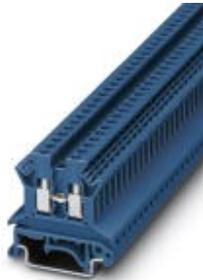
Durchgangsklemme, Nennspannung: 800 V, Nennstrom: 24 A, Anschlussart: Schraubanschluss, Anzahl der Anschlüsse: 2, Querschnitt: 0,2 mm<sup>2</sup> - 4 mm<sup>2</sup>, AWG: 24 - 12, Breite: 5,2 mm, Farbe: blau, Montageart: NS 35/7,5, NS 35/15, NS 32
