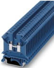
Durchgangsklemme, Nennspannung: 800 V, Nennstrom: 32 A, Anschlussart: Schraubanschluss, Anzahl der Anschlüsse: 2, Querschnitt: 0,2 mm<sup>2</sup> - 6 mm<sup>2</sup>, AWG: 24 - 10, Breite: 6,2 mm, Farbe: blau, Montageart: NS 35/7,5, NS 35/15, NS 32
