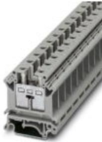
Installationsklemme, Schraubanschluss, Querschnitt: 2,5 mm<sup>2</sup> - 25 mm<sup>2</sup>, AWG: 12 - 4, Breite: 12,2 mm, Farbe: grau, Montageart: NS 35/7,5, NS 35/15, NS 32
