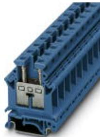
Durchgangsklemme, Nennspannung: 800 V, Nennstrom: 76 A, Anschlussart: Schraubanschluss, Anzahl der Anschlüsse: 2, Querschnitt: 2,5 mm<sup>2</sup> - 25 mm<sup>2</sup>, AWG: 14 - 4, Breite: 12,2 mm, Farbe: blau, Montageart: NS 35/7,5, NS 35/15, NS 32
