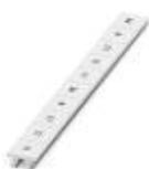
Marker für Klemmen, Streifen, weiß, beschriftet, beschriftbar mit: CMS-P1-PLOTTER, längs: L1, L2, L3, N, PE, L1, L2, L3, N, PE, Montageart: verrasten in hoher Schildchennut, für Klemmenbreite: 10,2 mm, Schriftfeldgröße: 10,15 x 10,5 mm
