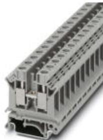
Durchgangsklemme, Nennspannung: 800 V, Nennstrom: 57 A, Anschlussart: Schraubanschluss, Anzahl der Anschlüsse: 2, Querschnitt: 0,5 mm<sup>2</sup> - 16 mm<sup>2</sup>, AWG: 20 - 6, Breite: 10,2 mm, Farbe: grau, Montageart: NS 35/7,5, NS 35/15, NS 32
