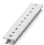
Zackband, Streifen, weiß, beschriftet, beschriftbar mit: CMS-P1-PLOTTER, quer bedruckt: fortlaufende Zahlen 1-10, 11-20 usw. bis 491-500, Montageart: verrasten in hoher Schildchennut, für Klemmenbreite: 6,2 mm, Schriftfeldgröße: 6,15 x 10,5 mm
