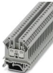
Durchgangsklemme, Nennspannung: 800 V, Nennstrom: 32 A, Anschlussart: Schraubanschluss, Anzahl der Anschlüsse: 2, Polzahl: 1, Querschnitt: 0,2 mm<sup>2</sup> - 4 mm<sup>2</sup>, AWG: 24 - 12, Breite: 6,2 mm, Farbe: grau, Montageart: NS 35/7,5, NS 35/15, NS 32
