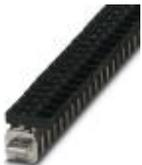
Anschlussklemme, Anschlussart: Schraubanschluss, Belastungsstrom: 41 A, Querschnitt: 0,5 mm<sup>2</sup> - 6 mm<sup>2</sup>, Breite: 7 mm, Farbe: schwarz
