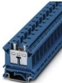
Installationsklemme, Schraubanschluss, Querschnitt: 2,5 mm<sup>2</sup> - 25 mm<sup>2</sup>, AWG: 12 - 4, Breite: 12,2 mm, Farbe: blau, Montageart: NS 35/7,5, NS 35/15, NS 32
