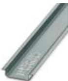
Tragschiene ungelocht, Standardprofil, Breite: 35 mm, Höhe: 7,5 mm, nach EN 60715: 2001, Material: Stahl, verzinkt, weiß-passiviert, Länge: 2000 mm, Farbe: weiß
