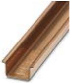
Tragschiene ungelocht, Standardprofil, Breite: 35 mm, Höhe: 15 mm, ähnlich EN 60715: 2001, Material: Kupfer, unbeschichtet, Länge: 2000 mm, Farbe: kupferfarben
