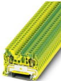
Zugfeder-Schutzleiterklemme, Anschlussart: Zugfederanschluss, Anzahl der Anschlüsse: 2, Querschnitt: 0,08 mm<sup>2</sup> - 4 mm<sup>2</sup>, AWG: 28 - 12, Breite: 5,2 mm, Farbe: grün-gelb, Montageart: NS 35/7,5, NS 35/15
