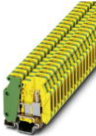
Mini-Schutzleiterklemme, Anschlussart: Schraubanschluss, Anzahl der Anschlüsse: 2, Querschnitt: 0,2 mm 2 - 4 mm 2 , AWG: 24 - 12, Breite: 5,2 mm, Farbe: grün-gelb, Montageart: NS 15
