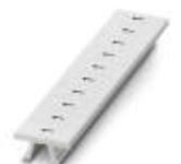
Zackband, Streifen, weiß, beschriftet, beschriftbar mit: CMS-P1-PLOTTER, längs bedruckt: gleiche Zahlen 1 oder 2 usw. bis 100, Montageart: verrasten in hoher Schildchennut, für Klemmenbreite: 5,2 mm, Schriftfeldgröße: 5,15 x 10,5 mm
