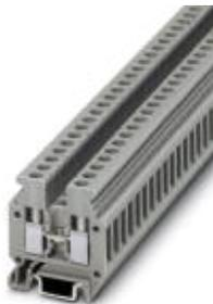
Mini-Durchgangsklemme, Nennspannung: 500 V, Nennstrom: 24 A, Anschlussart: Schraubanschluss, Anzahl der Anschlüsse: 2, Querschnitt: 0,2 mm<sup>2</sup> - 4 mm<sup>2</sup>, AWG: 24 - 12, Breite: 5,2 mm, Farbe: grau, Montageart: NS 15
