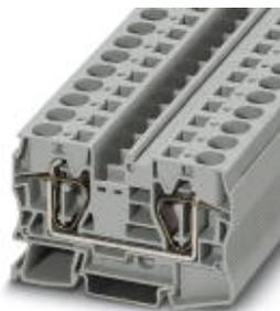
Durchgangsklemme, Nennspannung: 1000 V, Nennstrom: 76 A, Anschlussart: Zugfederanschluss, Anzahl der Anschlüsse: 2, Querschnitt: 0,2 mm<sup>2</sup> - 25 mm<sup>2</sup>, AWG: 24 - 4, Breite: 12,2 mm, Farbe: grau, Montageart: NS 35/7,5, NS 35/15
