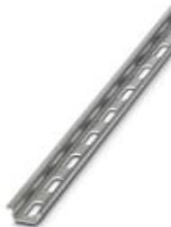
Tragschiene gelocht, Standardprofil, Breite: 15 mm, Höhe: 5,5 mm, nach EN 60715: 2001, Material: Aluminium, unbeschichtet, Länge: 2000 mm, Farbe: silberfarben
