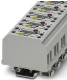
Erdtrennklemme mit Schraubanschluss, Spannung 24 - 48 V AC/DC, Strom: 3,5 - 8 mA, Querschnitt: 0,5-6 mm<sup>2</sup>, Breite: 22,5 mm, Farbe: grau
