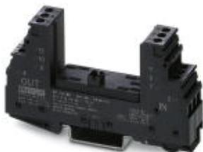
Basiselement für Schutzstecker PT mit Schutzschaltung für einen 2-adrige erdpotenzialfrei betriebenen Signalkreis. Montage auf NS 35/7,5 und NS 35/15, Gehäusebreite: 17,5 mm.
