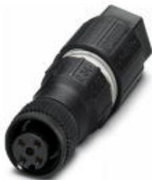
Sensor-/Aktor-Steckverbinder, Universal, 4-polig, Buchse gerade M12, A-kodiert, Schneidklemmanschluss, Rändelmaterial: Kunststoff, Kabelaußendurchmesser 4 mm ... 8 mm
