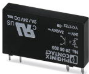
Steckbares Miniatur-Solid-State-Relais, Leistungs-Solid-State-Relais, 1 Schließer, Eingang: 24 V DC, Ausgang: 3-33 V DC/3 A
