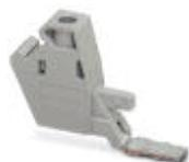
Abgriffklemme, Nennspannung: 1000 V, Nennstrom: 32 A, Anschlussart: Schraubanschluss, Anzahl der Anschlüsse: 1, Querschnitt: 0,14 mm<sup>2</sup> - 6 mm<sup>2</sup>, AWG: 26 - 10, Breite: 8,1 mm, Höhe: 24,7 mm, Farbe: grau, Montageart: auf Basiselement
