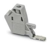
Abgriffklemme, Nennspannung: 1000 V, Nennstrom: 32 A, Anschlussart: Schraubanschluss, Anzahl der Anschlüsse: 1, Querschnitt:0,14 mm² - 6 mm², AWG: 26 - 10, Breite: 8,1 mm, Höhe: 24,7 mm, Farbe: grau, Montageart: auf Basiselement
