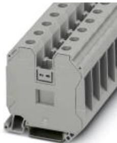
Durchgangsklemme, Nennspannung: 1000 V, Nennstrom: 125 A, Anschlussart: Schraubanschluss, Anzahl der Anschlüsse: 2, Querschnitt: 1,5 mm<sup>2</sup> - 50 mm<sup>2</sup>, AWG: 16 - 1/0, Breite: 16 mm, Höhe: 65,1 mm, Farbe: grau, Montageart: NS 35/7,5, NS 35/15
