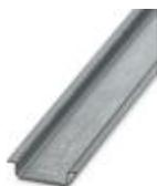
Tragschiene ungelocht, Standardprofil, Breite: 35 mm, Höhe: 7,5 mm, nach EN 60715: 2001, Material: Stahl, verzinkt, Länge: 2000 mm, Farbe: silberfarben
