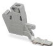
Abgriffklemme, Nennspannung: 1000 V, Nennstrom: 32 A, Anschlussart: Schraubanschluss, Anzahl der Anschlüsse: 1, Querschnitt: 0,14 mm<sup>2</sup> - 6 mm<sup>2</sup>, AWG: 26 - 10, Breite: 8,1 mm, Höhe: 25,7 mm, Farbe: grau, Montageart: auf Basiselement
