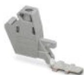
Abgriffklemme, Nennspannung: 1000 V, Nennstrom: 32 A, Anschlussart: Schraubanschluss, Anzahl der Anschlüsse: 1, Querschnitt: 0,14 mm² - 6 mm², AWG: 26 - 10, Breite: 8,1 mm, Höhe: 25,7 mm, Farbe: grau, Montageart: auf Basiselement
