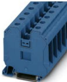
Durchgangsklemme, Nennspannung: 1000 V, Nennstrom: 125 A, Anschlussart: Schraubanschluss, Anzahl der Anschlüsse: 2, Querschnitt: 1,5 mm<sup>2</sup> - 50 mm<sup>2</sup>, AWG: 16 - 1/0, Breite: 16 mm, Höhe: 65,1 mm, Farbe: blau, Montageart: NS 35/7,5, NS 35/15
