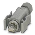
RJ45-Steckverbinder, Schutzart: IP67, Polzahl: 8, CAT5 (IEC 11801:2002), Material: PA, Anschlussart: IDC-Schnellanschluss, Anschlussquerschnitt: AWG 26-23, Kabelabgang: gerade, Farbe: verkehrsgrau A RAL 7042
