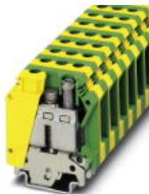
Schutzleiter-Reihenklemme, Anschlussart: Schraubanschluss, Anzahl der Anschlüsse: 2, Polzahl: 1, Querschnitt: 0,75 mm<sup>2</sup> - 50 mm<sup>2</sup>, AWG: 18 - 1/0, Breite: 15,2 mm, Farbe: grün-gelb, Montageart: NS 35/7,5, NS 35/15, NS 32
