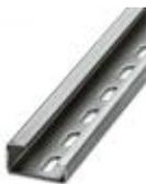
Tragschiene gelocht, G-Profil, Breite: 32 mm, Höhe: 15 mm, nach EN 60715: 2001, Material: Stahl, verzinkt, dickschichtpassiviert, Länge: 2000 mm, Farbe: silber
