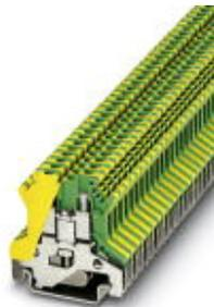
Schutzleiter-Reihenklemme, Anschlussart: Schraubanschluss, Anzahl der Anschlüsse: 2, Polzahl: 1, Querschnitt: 0,2 mm<sup>2</sup> - 4 mm<sup>2</sup>, AWG: 24 - 12, Breite: 5,2 mm, Farbe: grün-gelb, Montageart: NS 35/7,5, NS 35/15, NS 32
