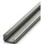
Tragschiene ungelocht, G-Profil, Breite: 32 mm, Höhe: 15 mm, nach EN 60715: 2001, Material: Stahl, verzinkt, dickschichtpassiviert, Länge: 2000 mm, Farbe: silberfarben
