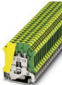
Schutzleiter-Reihenklemme, Anschlussart: Schraubanschluss, Anzahl der Anschlüsse: 2, Polzahl: 1, Querschnitt: 0,2 mm<sup>2</sup> - 4 mm<sup>2</sup>, AWG: 24 - 12, Breite: 6,2 mm, Farbe: grün-gelb, Montageart: NS 35/7,5, NS 35/15, NS 32
