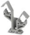
Doppel-Auflagebock, aus Isolierstoff, wahlweise verwendbar für Sammelschiene 3 x 10 mm oder 6 x 6 mm, Höhe in geschlossenem Zustand: 39 mm
