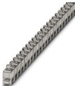
Abgriffklemme, Anschlussart: Schraubanschluss, Belastungsstrom: 125 A, Querschnitt: 2,5 mm<sup>2</sup> - 35 mm<sup>2</sup>, Breite: 14,3 mm, Farbe: silberfarben
