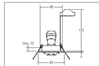
Einbaustrahler, GZ10, edelstahl, rund. Ausgeführt in kompakter Bauform für werkzeuglose Schnellmontage zum Deckeneinbau. Inkl. Bügel mit GZ10-Fassung zur normgerechten Zugentlastung. Ausführung: GZ10, Montageart: Einbaumontage, Montageort: Deckenmontage, Material: Edelstahl, Schutzart raumseitig: nach DIN EN 60529: IP20, Schutzklasse: (EN 61140) II, Spannung: 230V AC 50Hz, Leistung: 50W, Anzahl der Leuchtmittel / Fassungen: 1.0 Stk, Verstellbarkeit: schwenkbar, Art der Dimmung: sonstige .
